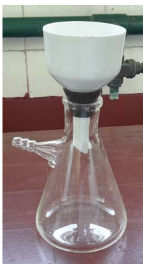
SM 12.4.1.2: Vacuum filtration apparatus
